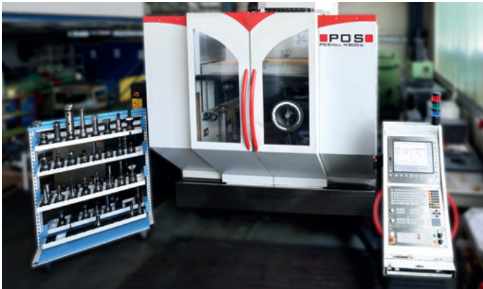
POS H800U X: 670 mm, Y: 830 mm, Z: 600 mm A: +/-120 °, C: 360 °, endlos, 5-Achs-Simultan Rundtisch Ø 800 mm, Heidenhain TNC 530
